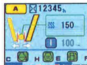
Sistema di regolazione dell'apertura di scarico completamente automatico
